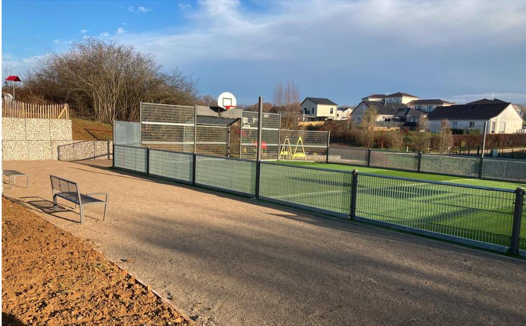
La structure est composée d'acier galvanisé et le sol est un gazon synthétique de 24 mm.
