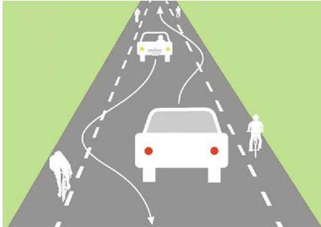
La chaussée à voie centrale banalisée est une chaussée étroite sans marquage axial dont les lignes de rive sont larges. **Les véhicules motorisés circulent sur une voie centrale bidirectionnelle** et les cyclistes sur la partie revêtue de l'accotement appelée rive.
